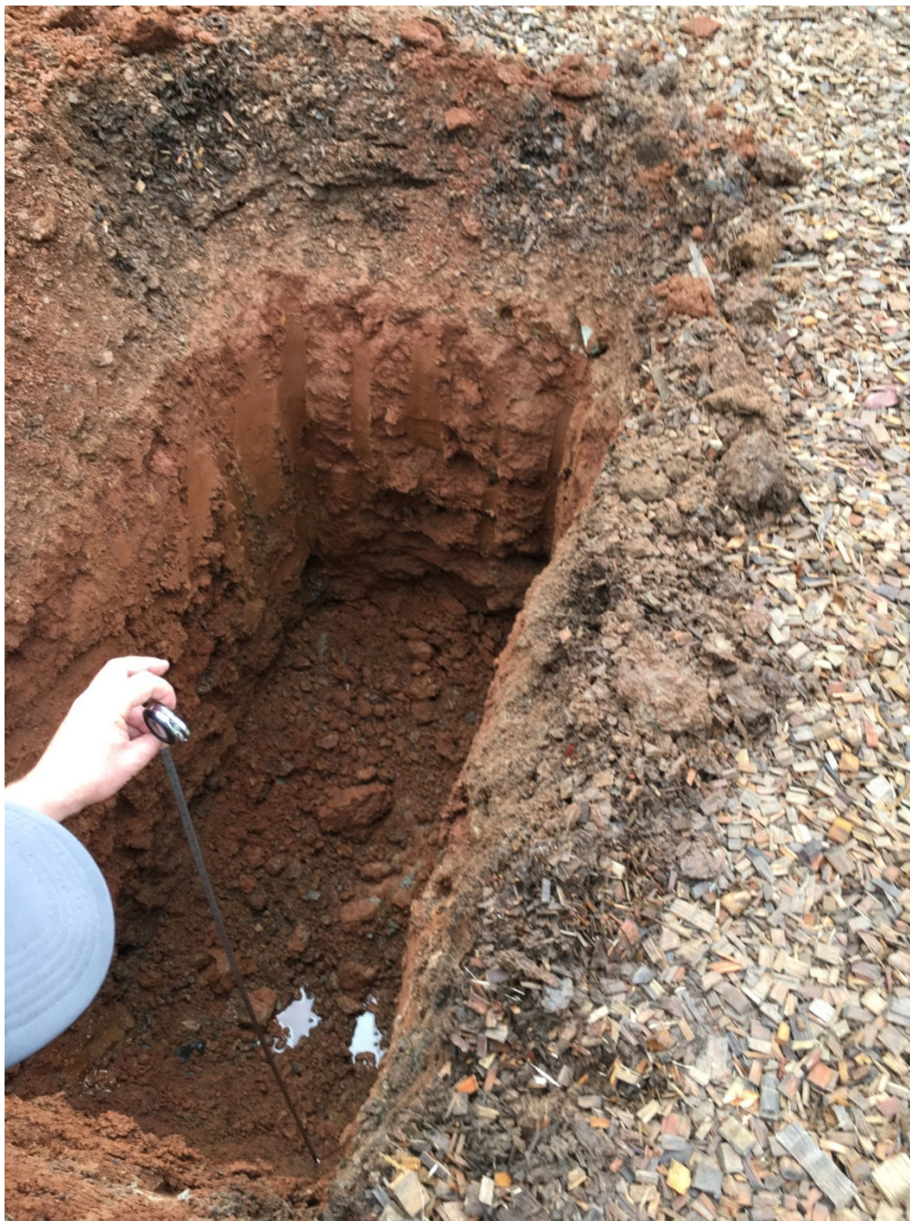
Encontrada rocha na profundidade aproximada de 1,50 metros.
