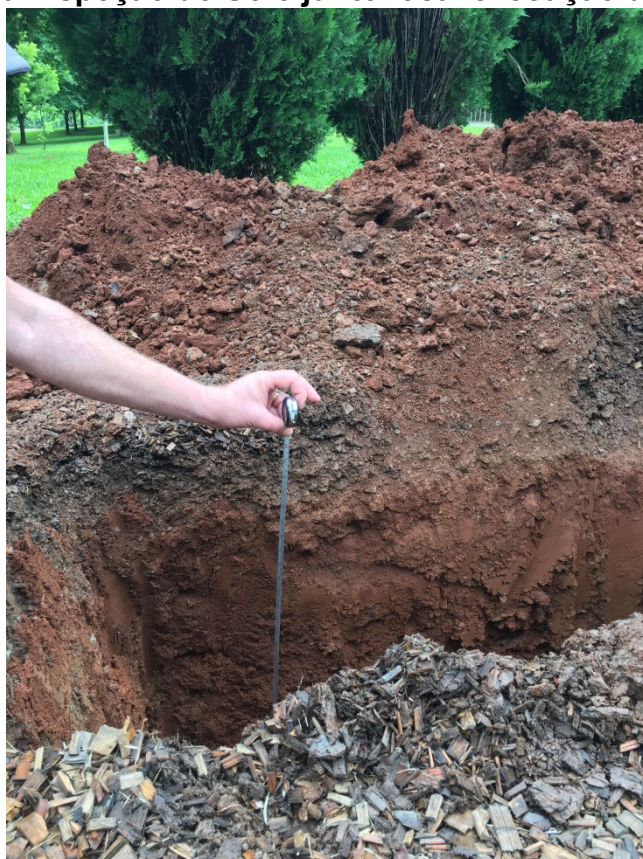
Material argiloso de alta compactação até profundidade de 1,50m.
