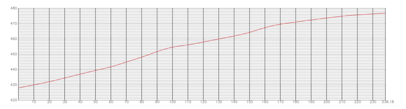
Projeção da pista em elevação, comprimento = 243,87m
