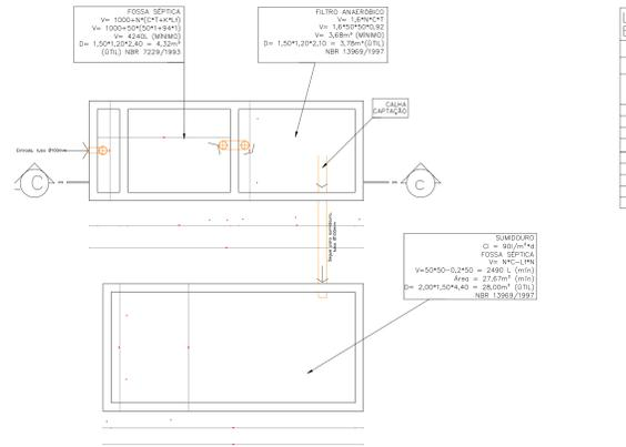
PLANTA BAIXA FOSSA SÉPTICA, FILTRO ANAERÓBICO E SUMIDOURO
