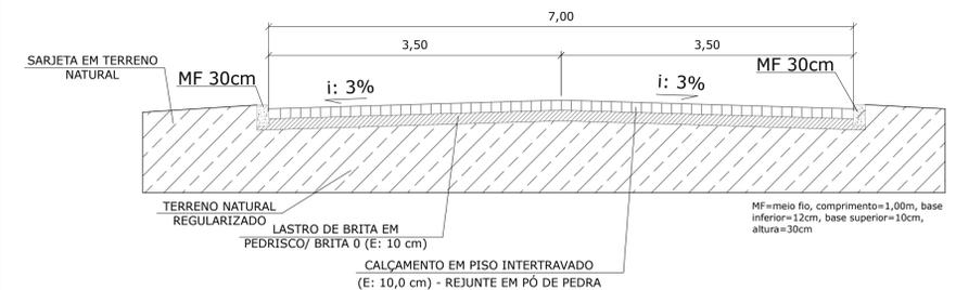
CORTE Aa - DETALHAMENTO DE SEÇÃO TRANSVERSAL DE PISTA A PAVIMENTAR ESC.: 1/40
