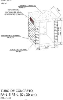
TUBO DE CONCRETO PA-1 E PS-1 (D: 30 cm) ESC.: 1/40
